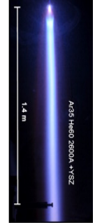
Colonnaire par PS-PVD (poudre fine voie sèche) (Oerlikon Metco; Malko Gindrat)
