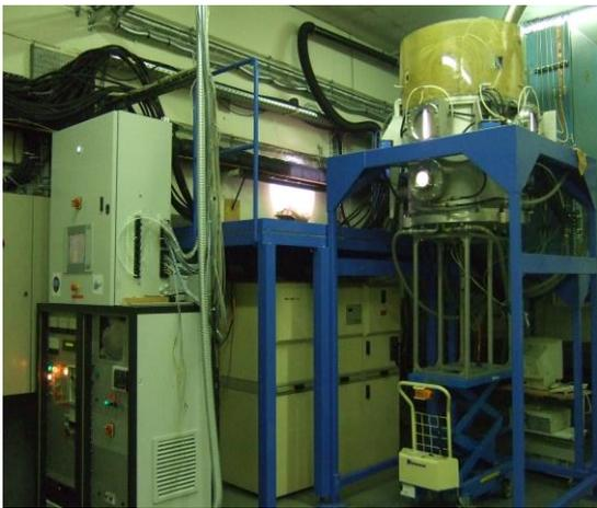
**Enceinte inox double paroi** :  $\Phi=100\text{cm}$ ,  $h=60\text{cm}$ , 6 hublots ( $\Phi=20\text{cm}$ ) pour spectroscopie, vide primaire/atmosphérique
