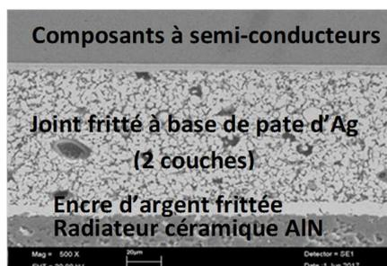
Figure 2 : Micrographie de la liaison entre un composant à semi-conducteur et un radiateur électrique
